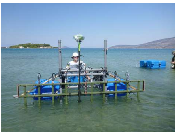
Κοιλάδα Αργολίδας. Εξοπλισμός υποβρύχιας τοπογραφικής αποτύπωσης (φωτ. ΥΠΠΟΑ).
