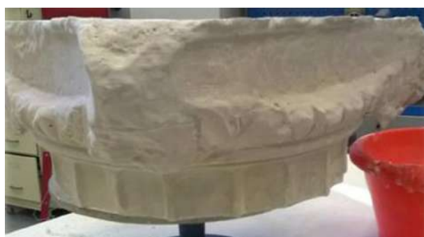
11. Πειραματική διαδικασία αντιγραφής κιονόκρανου από την «Οικία του Διονύσου» με 3D Printer (Αρχείο Τμήματος Συντήρησης ΕΦΑ Πέλλας, ΥΠΠΟ).
