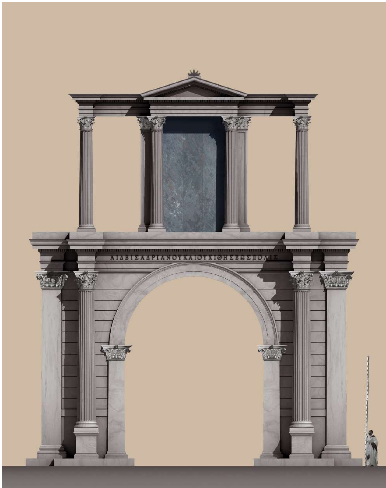
14. Η ανατολική όψη της αψίδας του Αδριανού με το ορθό ύψος των βάθρων και των κίωνων και το θωράκιο από υμήττειο μάρμαρο στον όροφο (Δ. Τσαλκάνης και Χ. Κανελλόπουλος).
