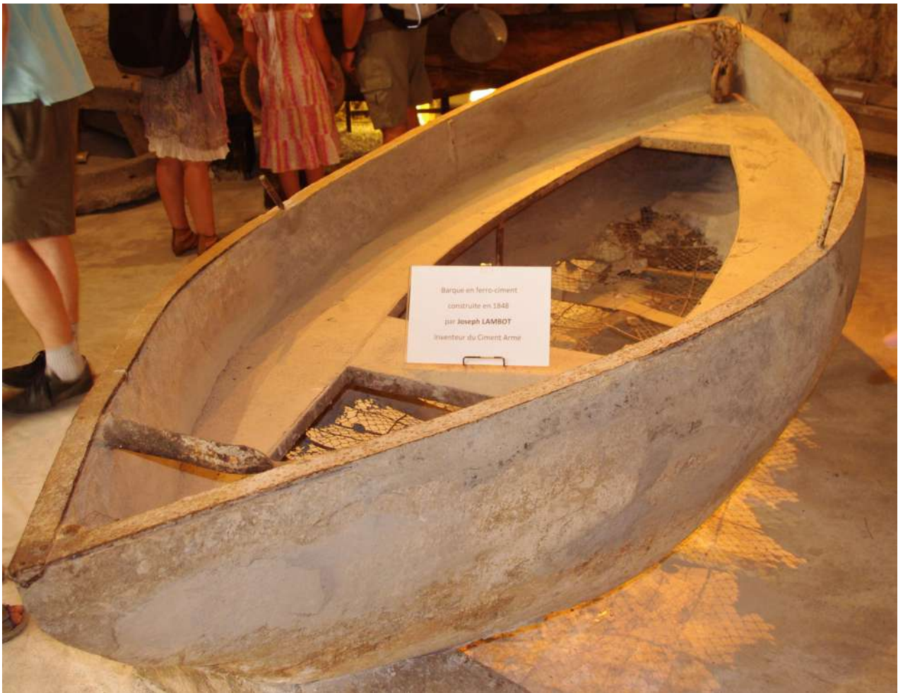
2. Βάρκα από οπλισμένο σκυρόδεμα ( ciment armé ) Joseph-Louis Lambot, 1848.
